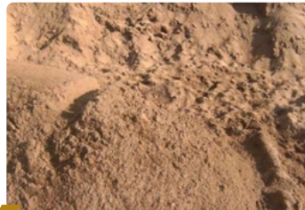
CÁT VÀNG HẠT LỚN ĐỔ BÊ TÔNG
